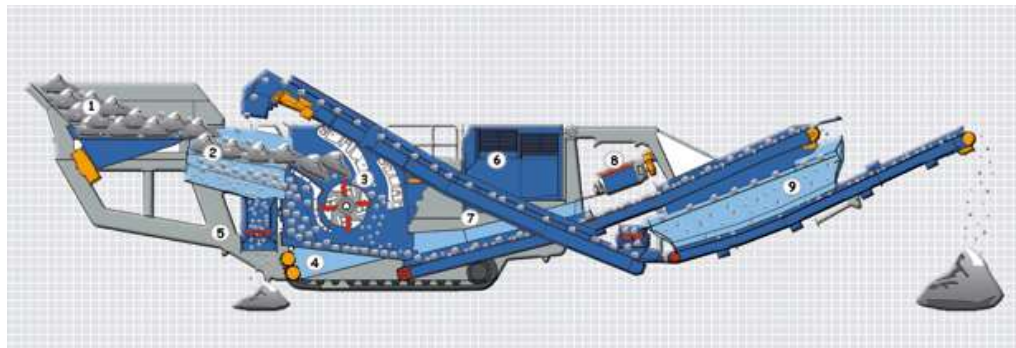
2 pav. Trupintuvo Kleeman Evo darbo schema
